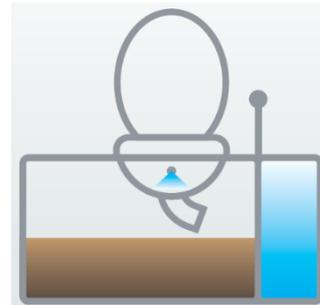
In particolar modo i bagni Sebach rientrano nella categoria prevista dalla suddetta norma dei **“bagni a serbatoio con vaso sanitario con sistema di scarico a flusso di acqua fresca ad attivazione a mano o a pedale (Tipo3 “AD ACQUA PULITA”)**, così come evidenziato nello schema sottostante
