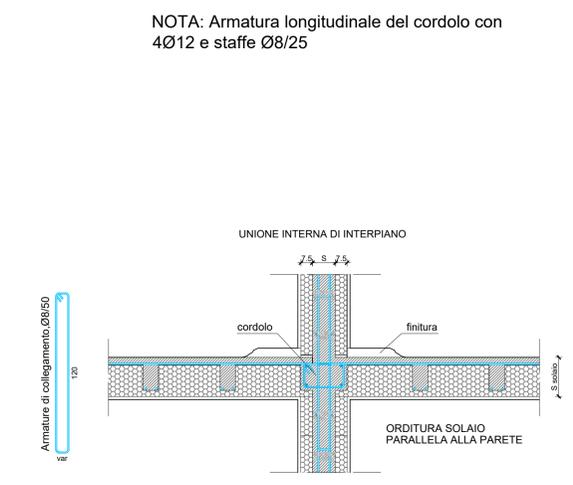
NOTA: Armatura longitudinale del cordolo con 4Ø12 e staffe Ø8/25
