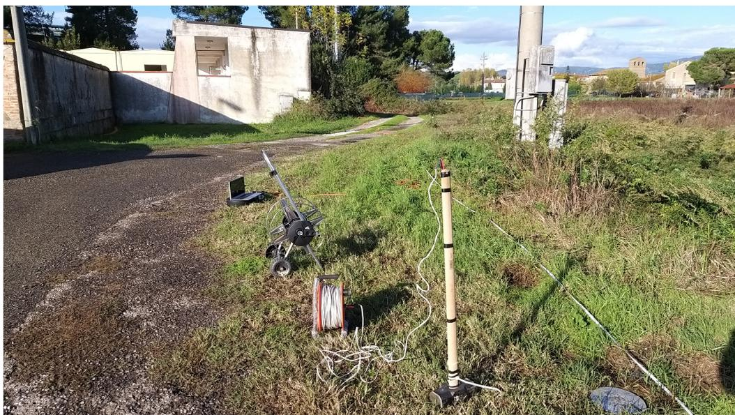
**Fig. 1 – Prospezione sismica MASW M1 effettuata in area progettuale.**
