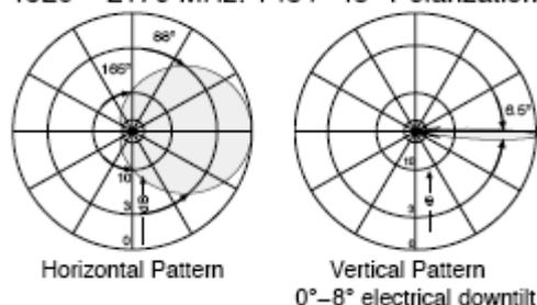
**Figura 1: diagramma di radiazione orizzontale (sinistra) e verticale (destra) di antenna UMTS**
