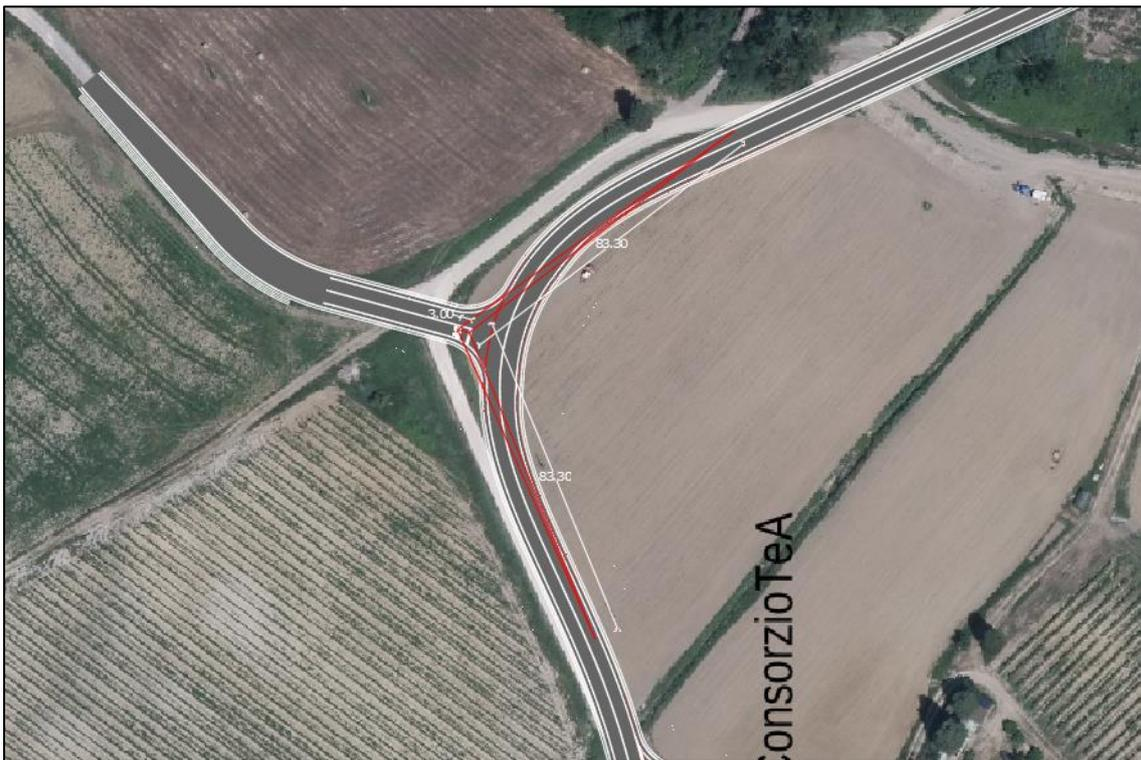
Figura 3. Triangoli di visibilità (in rosso) per l'intersezione di progetto con Via Poggio Piedi
