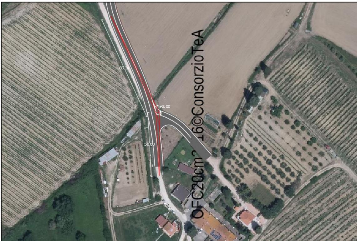
Figura 4. Triangoli di visibilità (in rosso) per l'intersezione di progetto con la strada poderale
