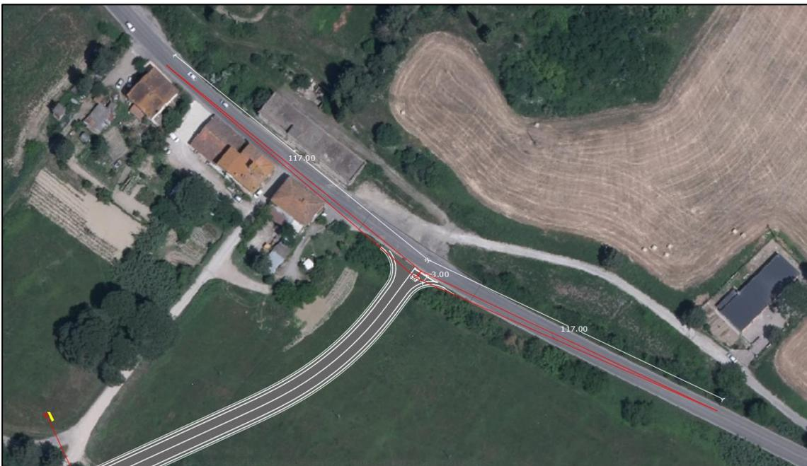
Figura 2. Triangoli di visibilità (in rosso) per l'intersezione di progetto con la SP 51
