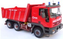
L'autocarro è una macchina utilizzata per il trasporto di mezzi, materiali da costruzione e/o di risulta da demolizioni o scavi, ecc., costituita essenzialmente da una cabina, destinata ad accogliere il conducente ed un cassone generalmente ribaltabile, per mezzo di un sistema oleodinamico.
