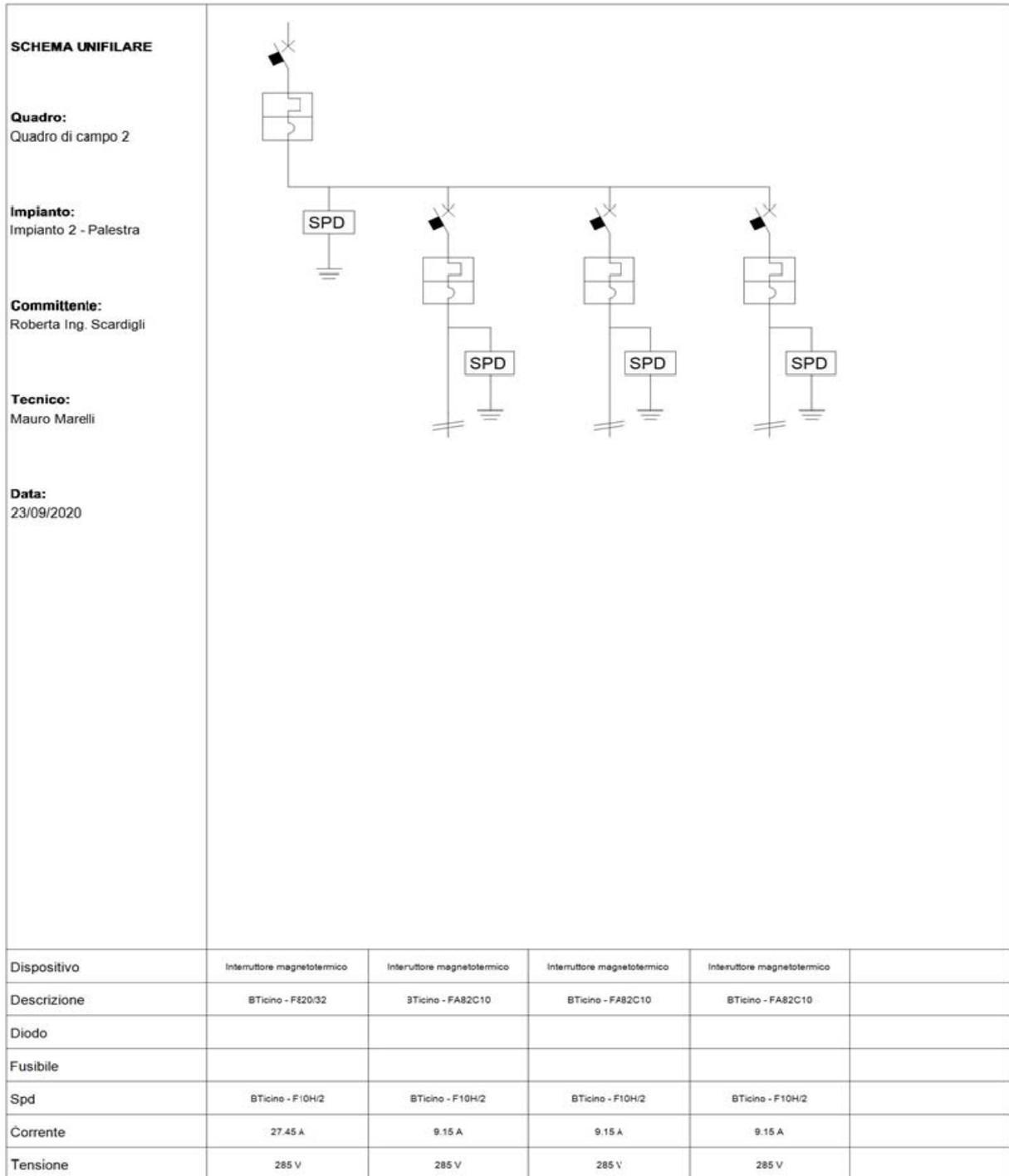
Fig. 8: Schema unifilare quadro "Quadro di campo 2"
