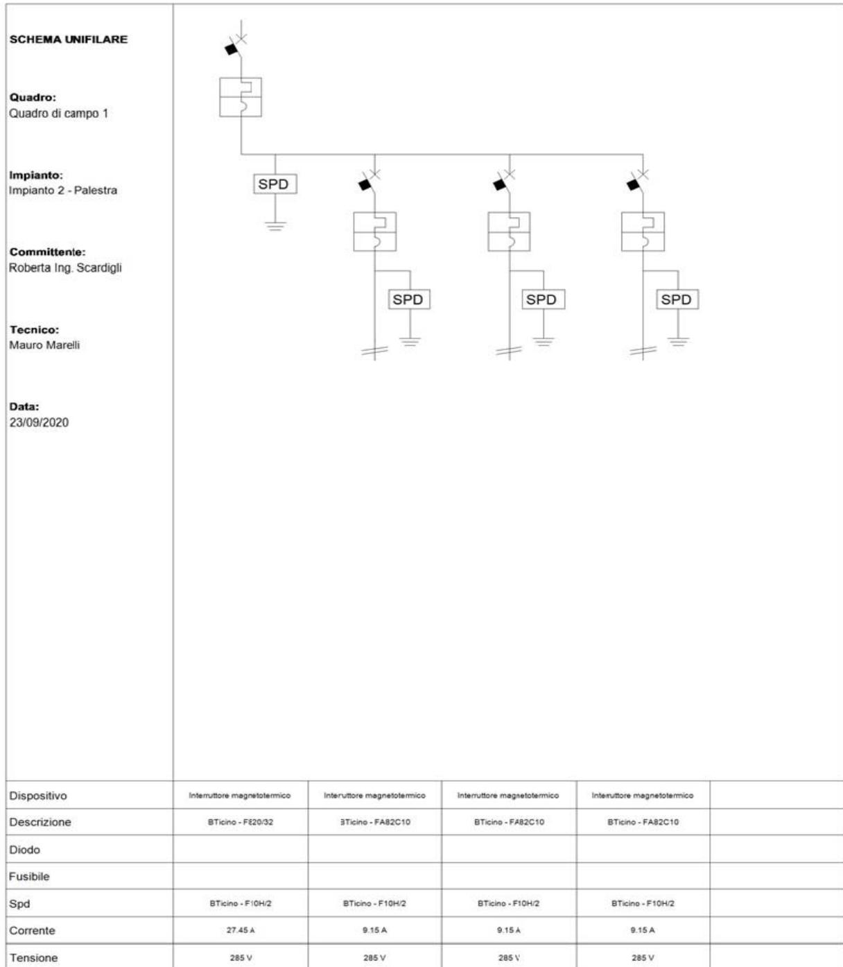
Fig. 7: Schema unifilare quadro "Quadro di campo 1"
