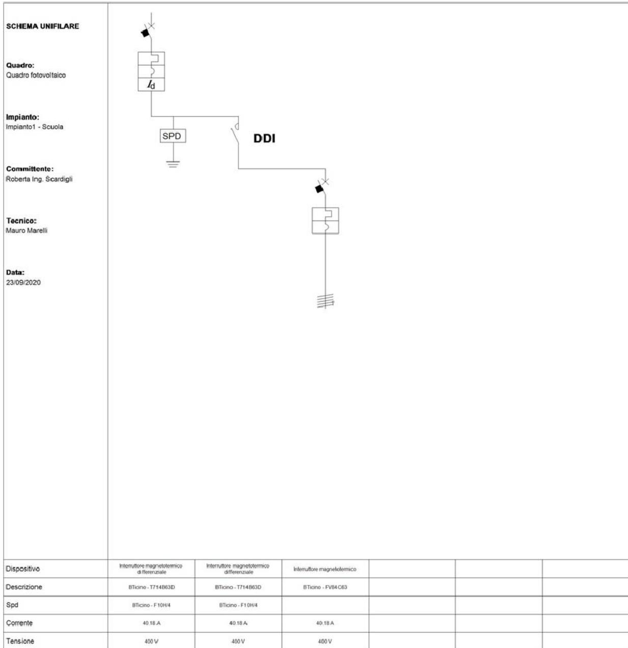
Fig. 6: Schema unifilare quadro "Quadro fotovoltaico"
