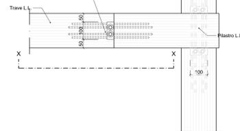
**B2 COLLEGAMENTO TRAVE LL 20X56 DI COPERTURA MENSA AL PILASTRO LAMELLARE**
