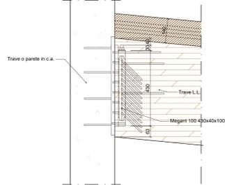
**B2 COLLEGAMENTO TRAVE LL 20X68 DI COPERTURA MENSA AL PILASTRO LAMELLARE**
